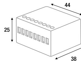
Quote espresse in "mm" - Dimensions expressed in "mm" - Medidas expresadas en "mm" - Dimensions exprimées en "mm" - Maße ausgedrückt in "mm"
