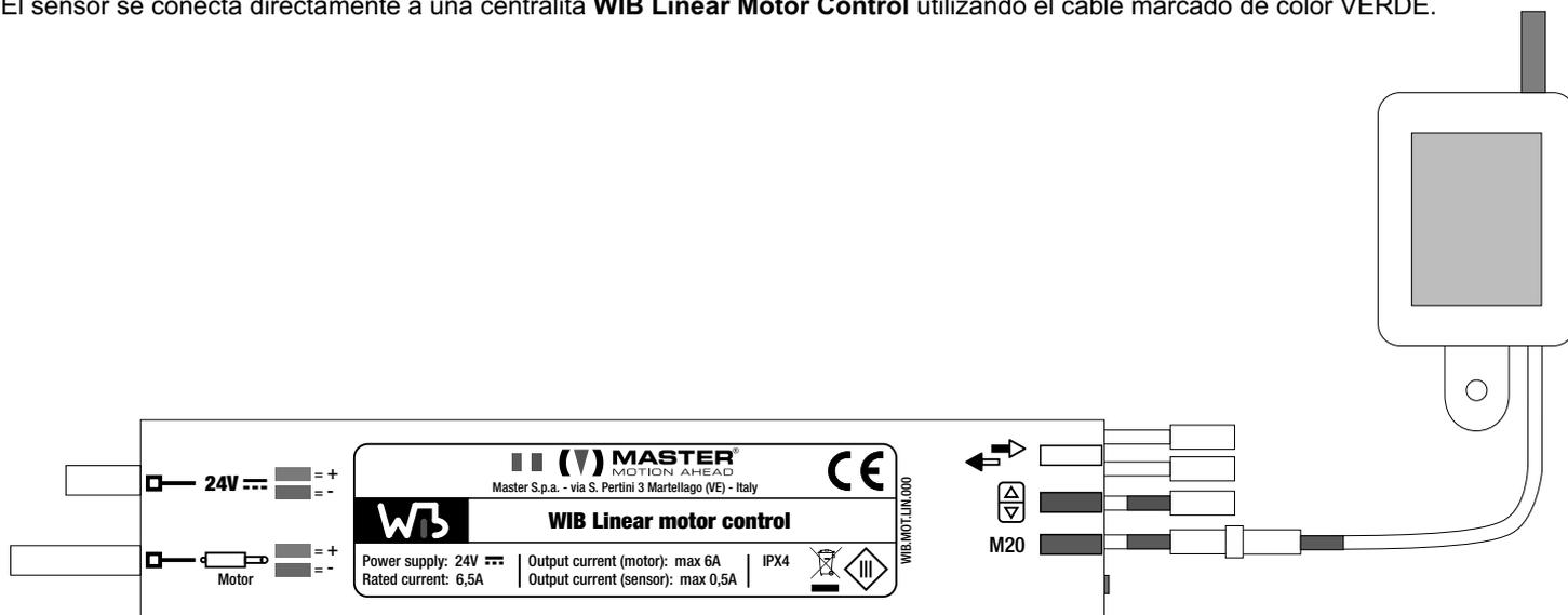
Para la conexión a dos centralitas utilice el repartidor WIB.SMT.004.000.
