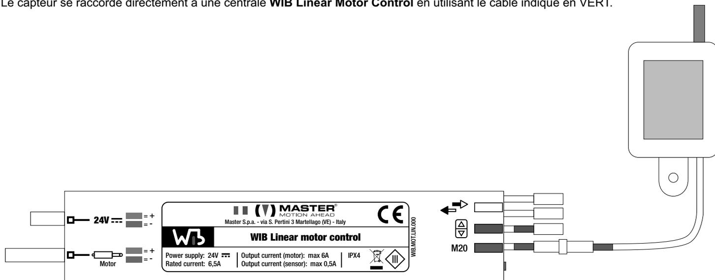
Pour le raccordement à deux centrales, il faut utiliser le séparateur WIB.SMT.004.000.
