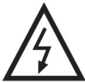
Apparecchiatura funzionante alla tensione di rete.
