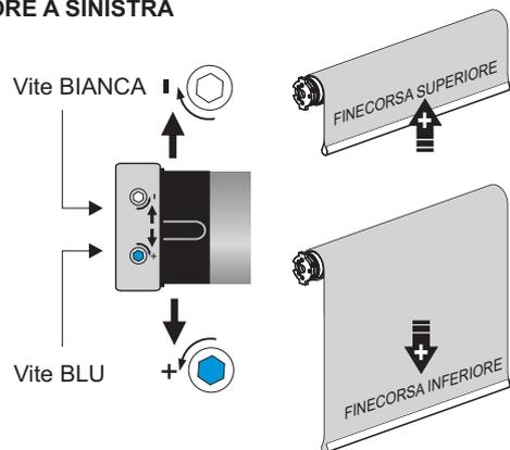
Se il telo si avvolge da dietro il rullo, le viti di regolazione risultano invertite: la vite blu regola il finecorsa superiore, la vite bianca regola quello inferiore
