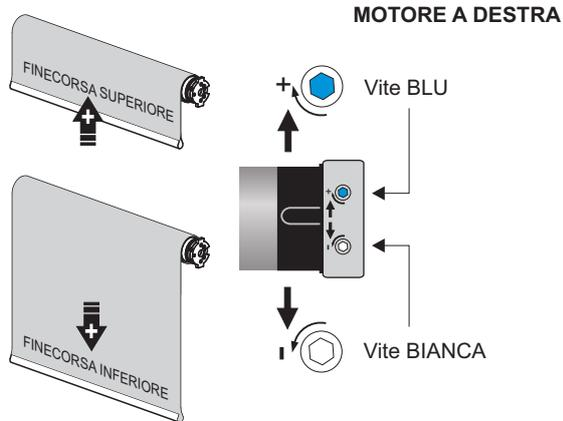
Se il telo si avvolge da dietro il rullo, le viti di regolazione risultano invertite: la vite blu regola il finecorsa inferiore, la vite bianca regola quello superiore
